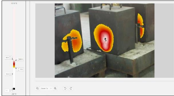
次の画像は JPG/IS5 ファイルの表示を示しており、アラーム温度範囲内のピクセルは黄色で表示され、その他の領域は通常の IR 画像として表示されます。
